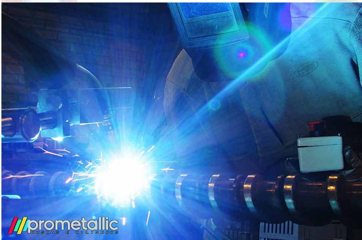
Recuperação de roscas e cilindros de máquinas injetoras, extrusoras e sopradoras. Recuperação e confecção de ponteiras, anéis de bloqueio, colunas e porcas de máquinas injetoras, sistema de articulação (fechamento) de injetoras. Aplicação de solda de liga de cobertura e bimetálica. Brunimento em cilindro, serviço de prensa e polimento.
